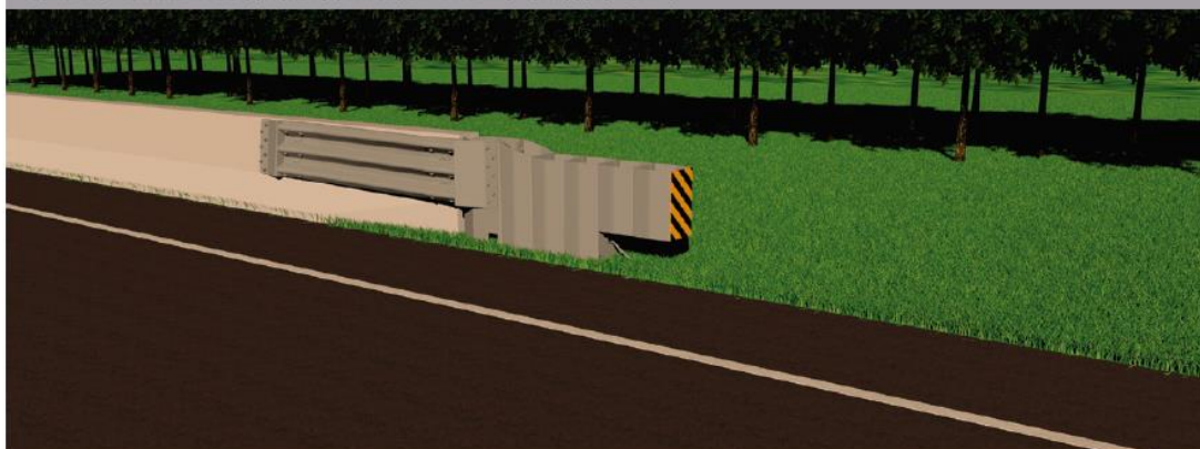
CONEXÃO À BARREIRA DE CONCRETO SIMPLES EM LATERAIS - OXT60840JNSMPS
