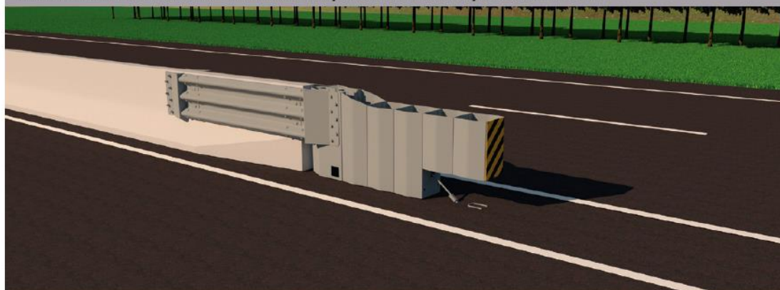
CONEXÃO À BARREIRA DE CONCRETO DUPLA PARA SEPARAÇÕES DE PISTAS E BIFURCAÇÕES - OXT60840JNDMP5
