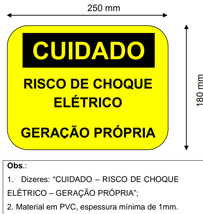
Figura 1: Placa de advertência junto ao padrão de entrada de energia.
